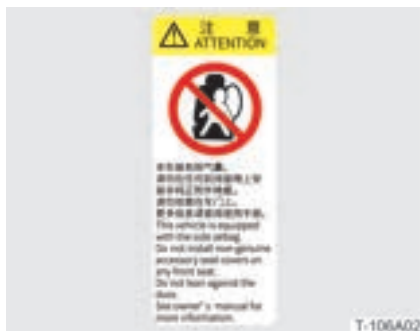
Waarschuwingsetiketten aan de onderzijde van de linker en rechter B-stijlen
