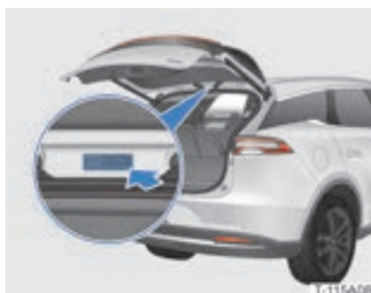
De type- en nummeretiketten van de achteraandrijfmotor zijn op de bagageruimteklep geplakt.
