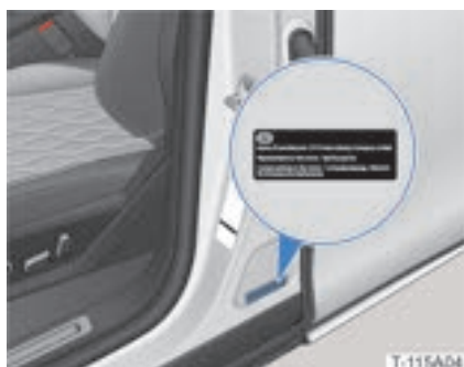
Het fabriekslabel bevindt zich aan de onderzijde van de linker B-stijl.
