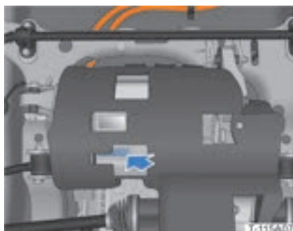
Het model en het nummer van de achteraandrijfmotor zijn op de behuizing van de achteraandrijfmotor gegraveerd.
