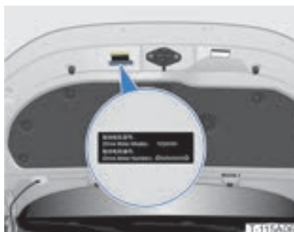
De model- en nummeretiketten van de vooraandrijfmotor zijn aan de binnenzijde van de voorklep geplakt.
